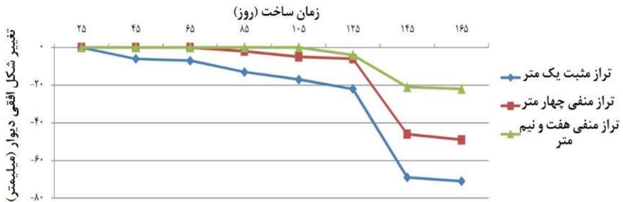
شکل ۷-۱. میزان متوسط تغییر شکل دیواره ضلع جنوبی گود در سه تراز +۱، -۴ و -۷/۵ متر نسبت به تراز خیابان در طول مدت گودبرداری و پایدارسازی گود پروژه میدان پلیس [۱۸]
