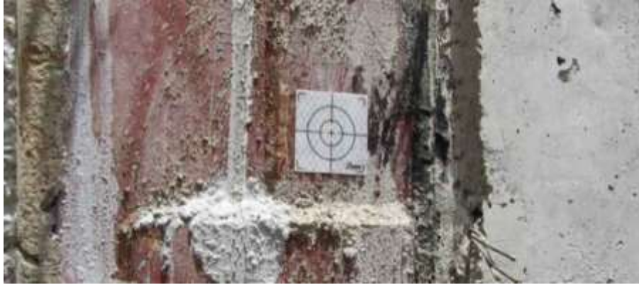
شکل ۳-۷. نمونه‌ای از منشور برچسبی نصب شده بر روی سازه نگهبان به منظور پایش تغییر شکل با دوربین توتال استیشن
