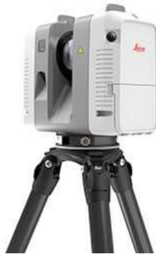
شکل ۳-۶. دستگاه اسکنر سه بعدی
