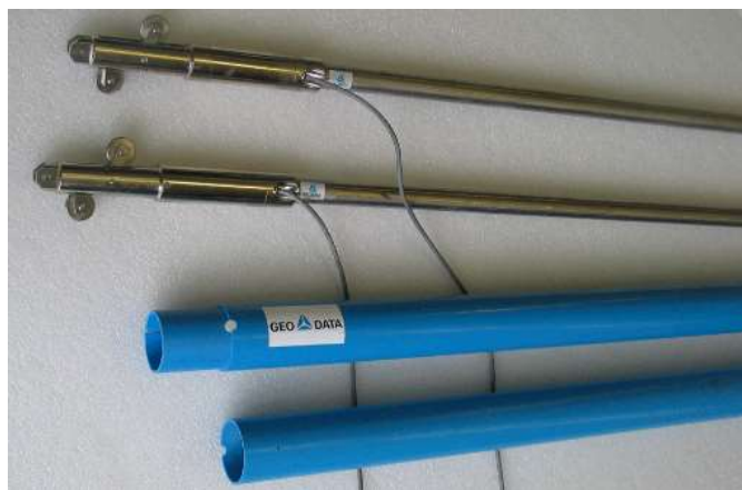
شکل ۳-۲. نمونه‌ای از کیسینگ و کاوشگر در دستگاه انحراف سنج
