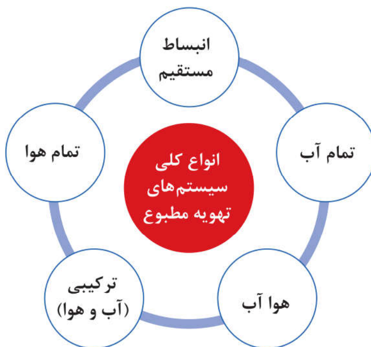
شکل ۱-۲: سیستم‌های تهویه مطبوع بر اساس عامل انتقال انرژی
