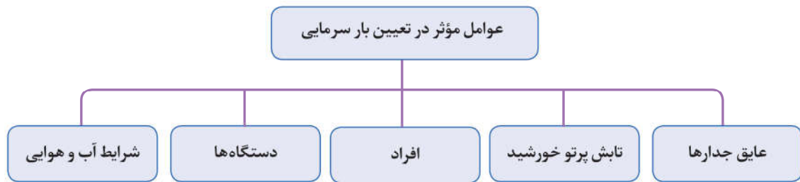
شکل ۳-۱: عوامل مؤثر در تعیین بار سرمایی.
